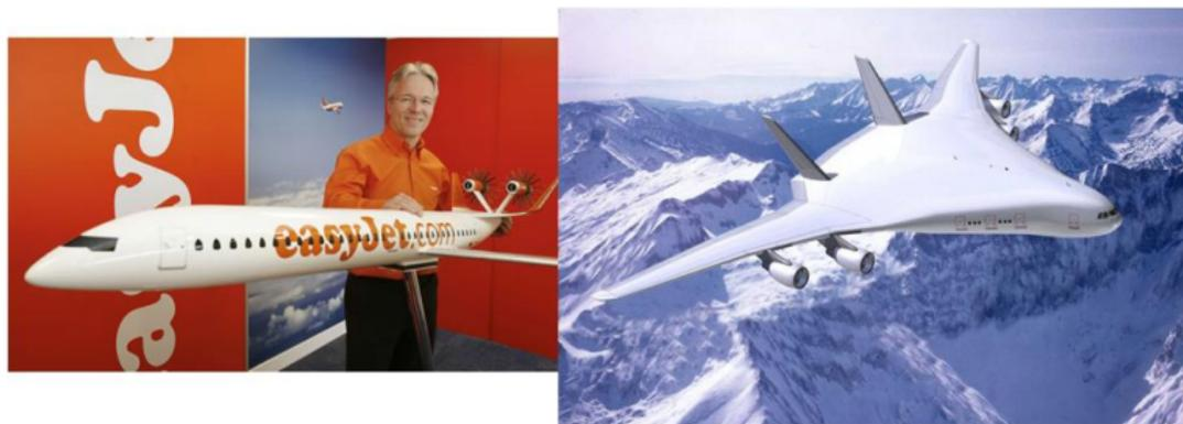
目前国外提出的新概念设计主要包括：基于对转发动机的低噪声飞行器设计，和基于翼身融合遮蔽噪声的低噪声飞行器设计。世界级主要研究机构包括英国Southampton大学，Cambridge大学，和美国Virginia Tech，Penn State，MIT等。
